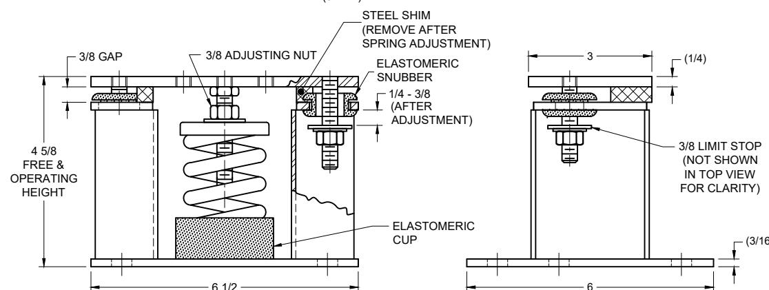
**MODEL MS-1C SEISMICALLY RESTRAINED VIBRATION ISOLATOR FOR 1" DEFLECTION**
